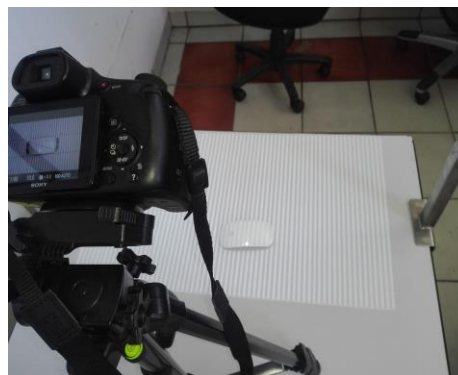
Fig. 4. Cámara de adquisición de imágenes de luz estructurada
